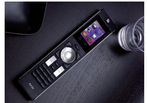
Telecomando universale Mio Modero R-4 di AMX ( www.amx.com ) con tecnologia wireless Zigbee e interfaccia touch
